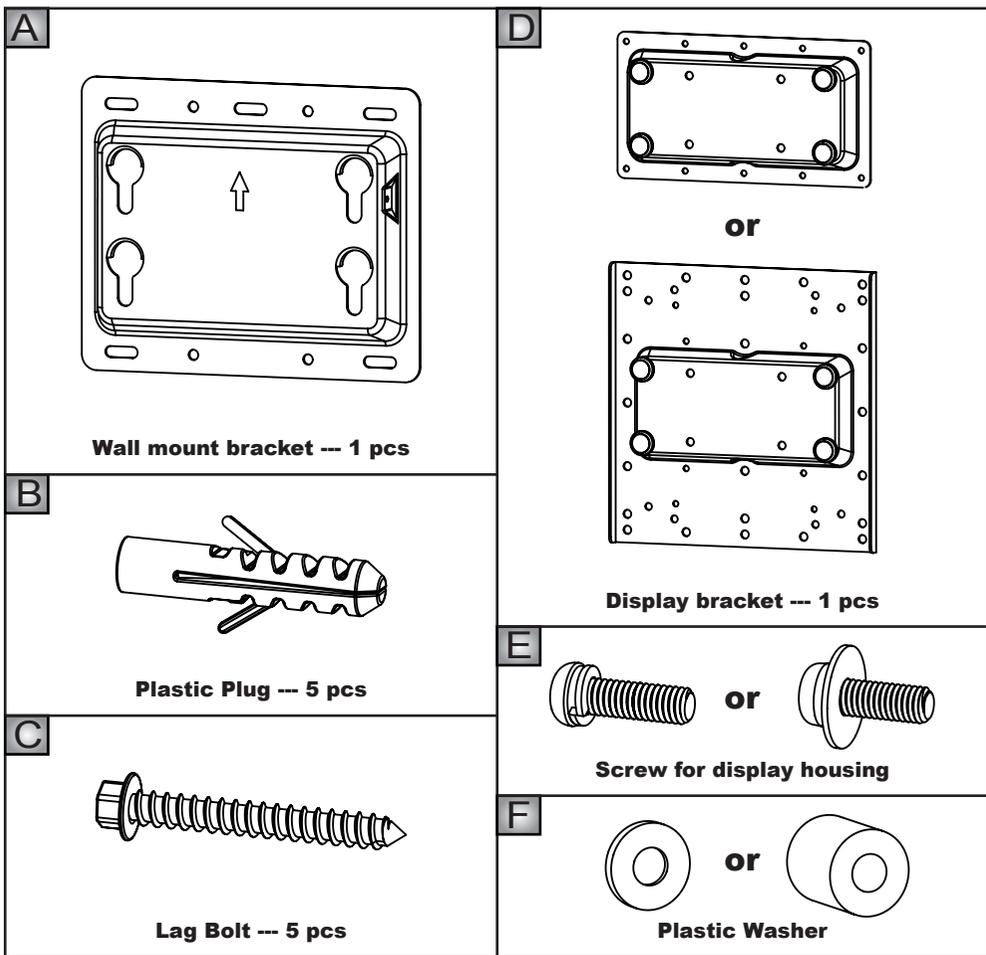
由於面板顯示器後殼壁掛螺絲孔規格不同，安裝前必須先確認本配件包所附的螺絲(E)規格及長度，是否適用你所要安裝的面板顯示器，若有問題請與你的經銷商聯絡。
